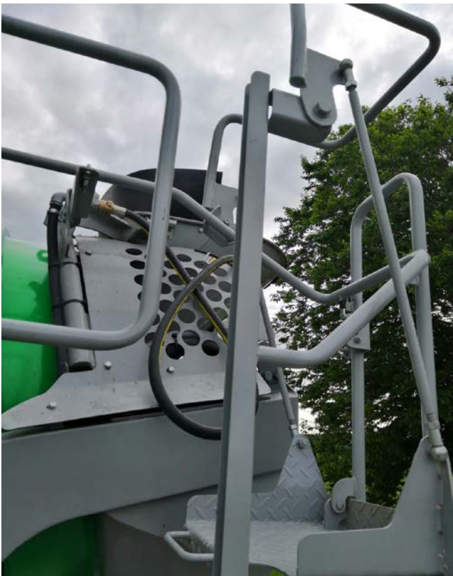
Abb. 22 Zusätzlicher klappbarer Aufstieg gestattet bessere Erreichbarkeit des Trichters
