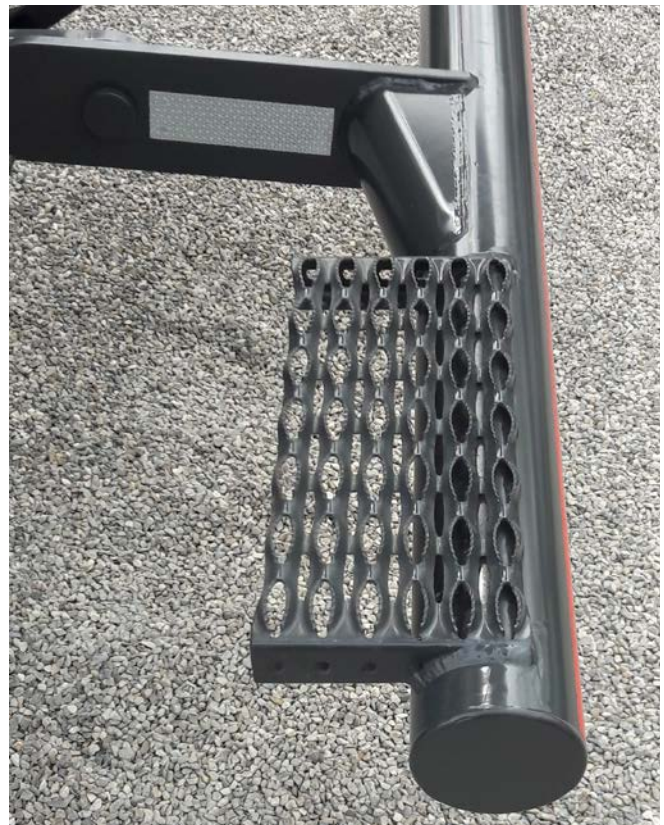
Abb. 23 Rutschhemmend gestaltete Standfläche
