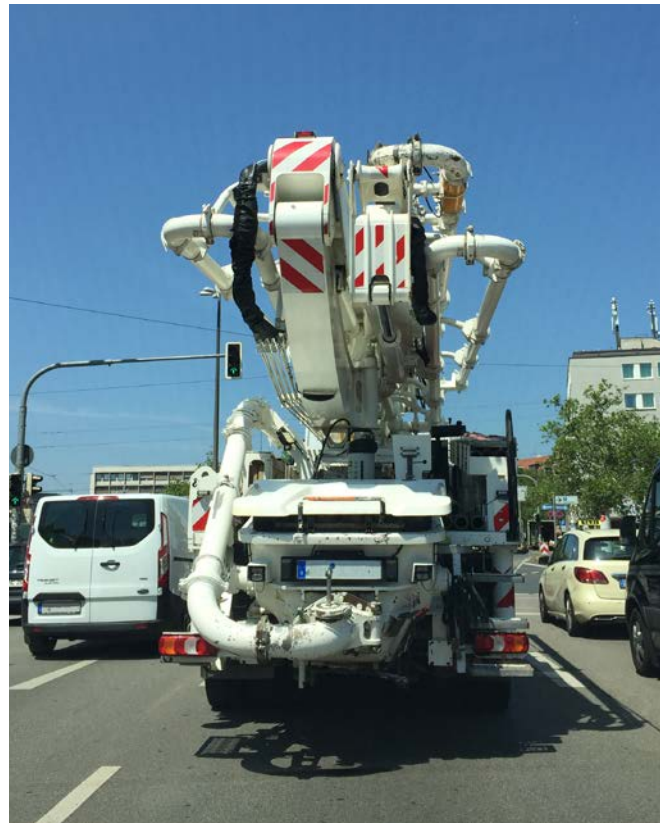
Abb. 27 Betonpumpe im Straßenverkehr
