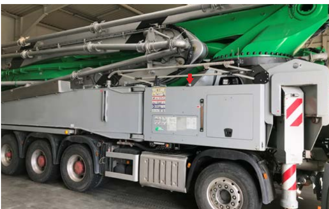
Abb. 30 Seitenkamera an der Betonpumpe
