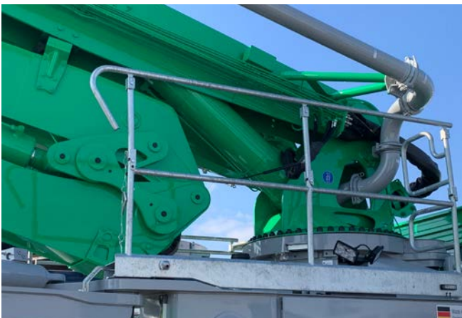
Abb. 24 Arbeitspodest und Absturzsicherung an der Betonpumpe
