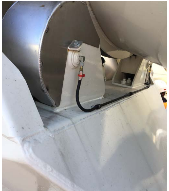
Abb. 8 Zentralschmierung Anschluss Tragrolle
