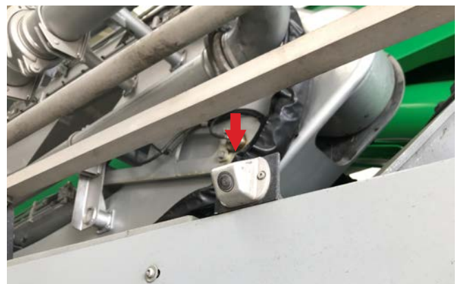
Abb. 31 Seitenkamera an der Betonpumpe
