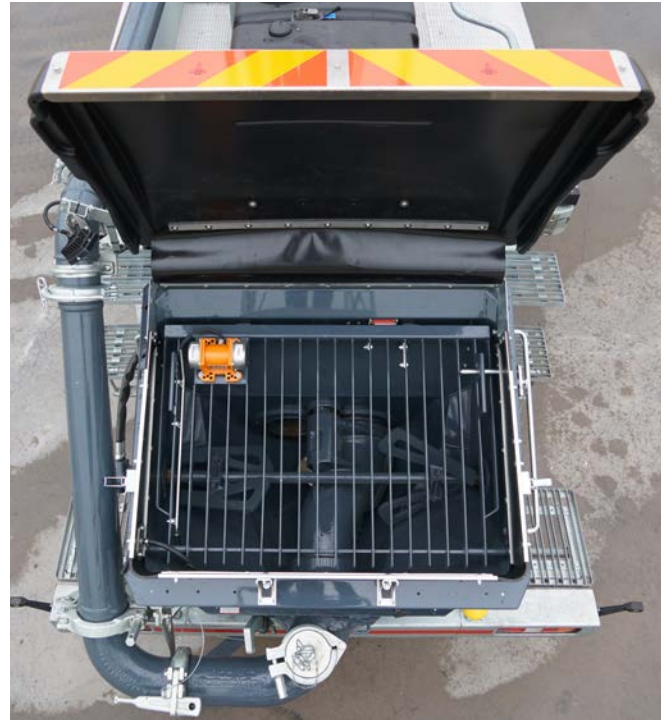
Abb. 38 Schutzeinrichtung, elektrisch verriegeltes Gitter, über dem Einfülltrichter der Betonpumpe
