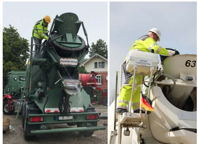
Abb. 21 Reinigen des Einlauftrichters und der Auslaufschurre
