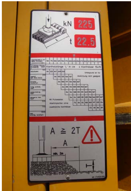
Abb. 32 Entscheidungshilfe für erforderliche lastverteilende Unterlagen
