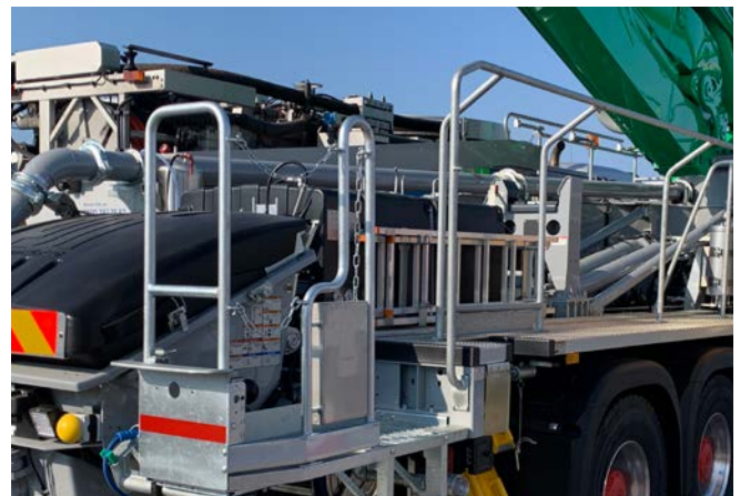
Abb. 25 Aufstieg und Arbeitspodest für die Reinigung des Einlauftrichters
