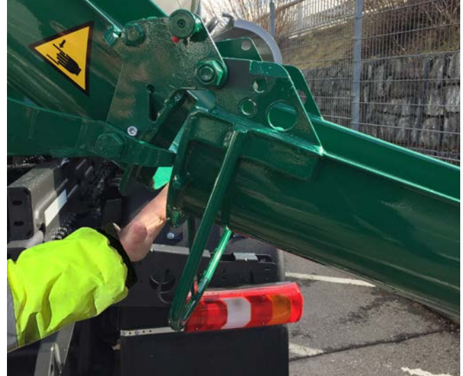
Abb. 17 Sicherung vor Quetschgefahr an der Auslaufschurre: Entriegelung nur mit beiden Händen möglich
