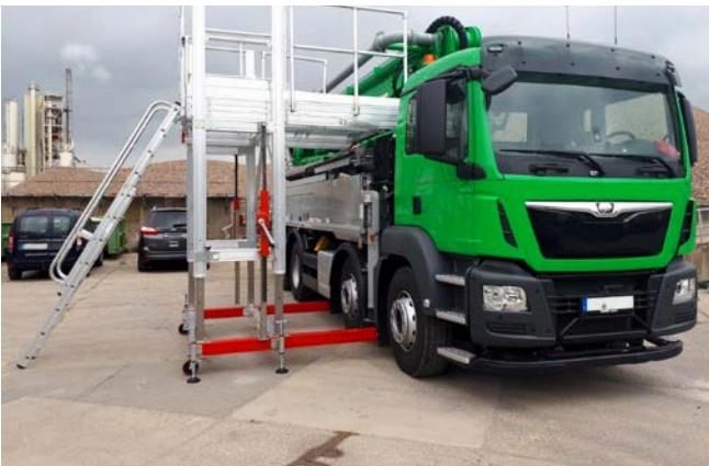
Abb. 41 Arbeitsbühne für die Instandsetzung einer Betonpumpe
