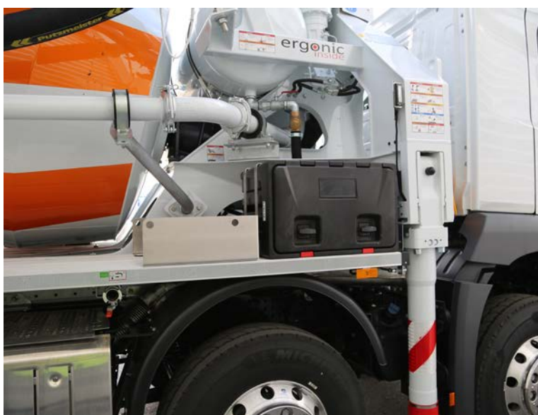
Abb. 12 Zubehörkasten am Fahrmischer für Kleinteile
