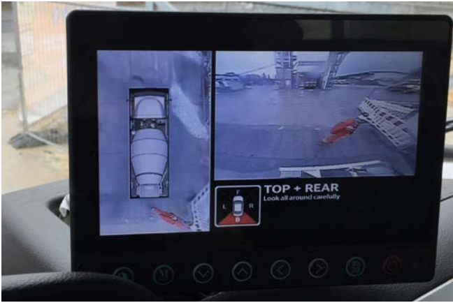
Abb. 13 Display in der Fahrerkabine für Abbiegeassistenten und „BirdView“-Kamerasystem
